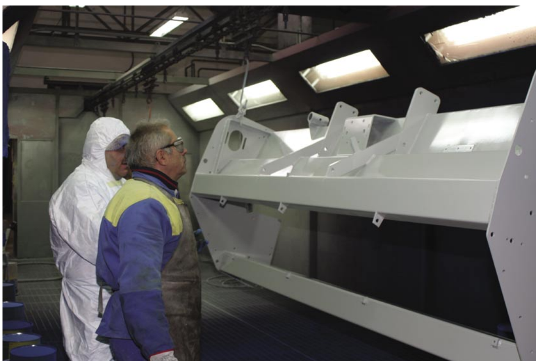
Fig. 13 - Vista interna della cabina di verniciatura con pavimento a cascata. I verniciatori controllano l'applicazione del fondo.
