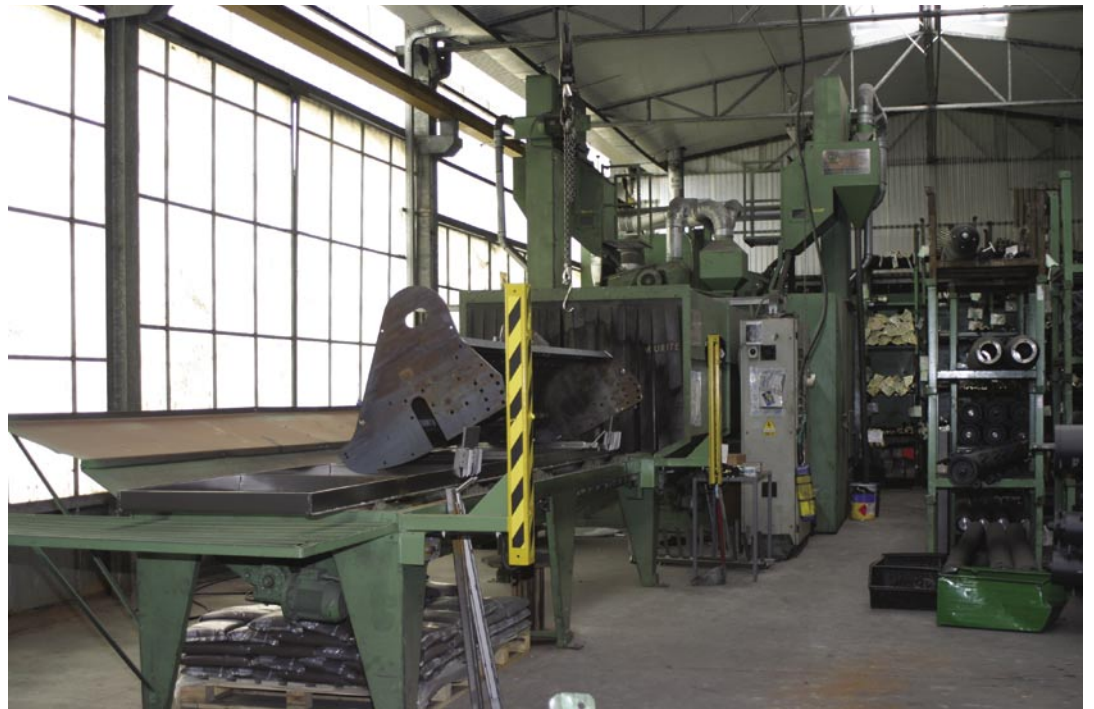
Fig. 10 - La granigliatrice a tunnel.
