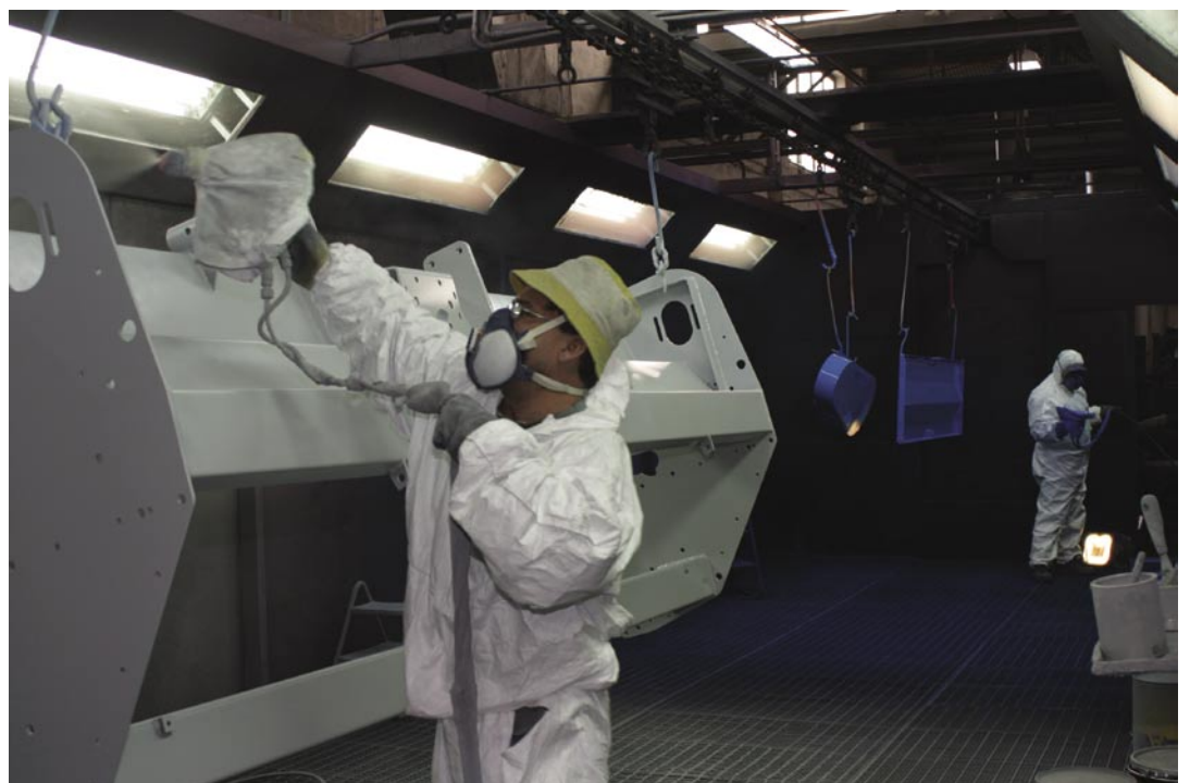
Fig. 11 - L'applicazione del fondo ad alto solido e, in secondo piano, l'applicazione "bagnato su bagnato" dello smalto all'acqua.
