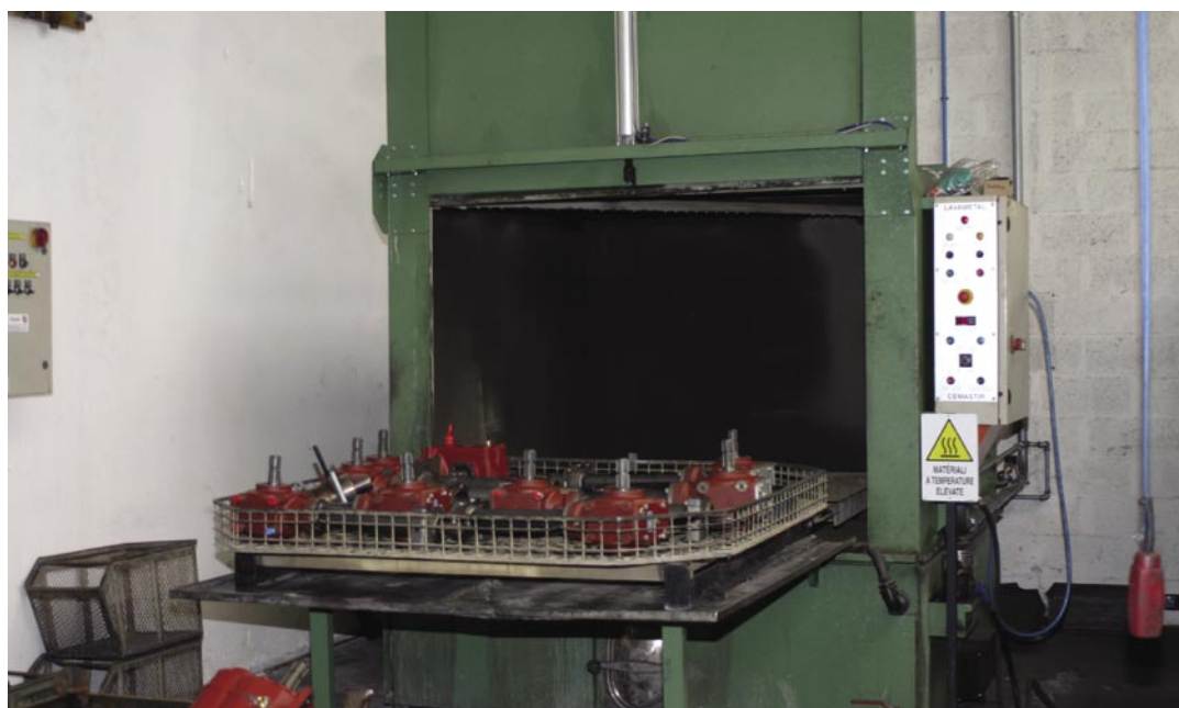
Figg. 6 e 7 - I telai delle macchine agricole prima della granigliatura al metallo quasi bianco, e dopo il trattamento, sopra a sinistra.
