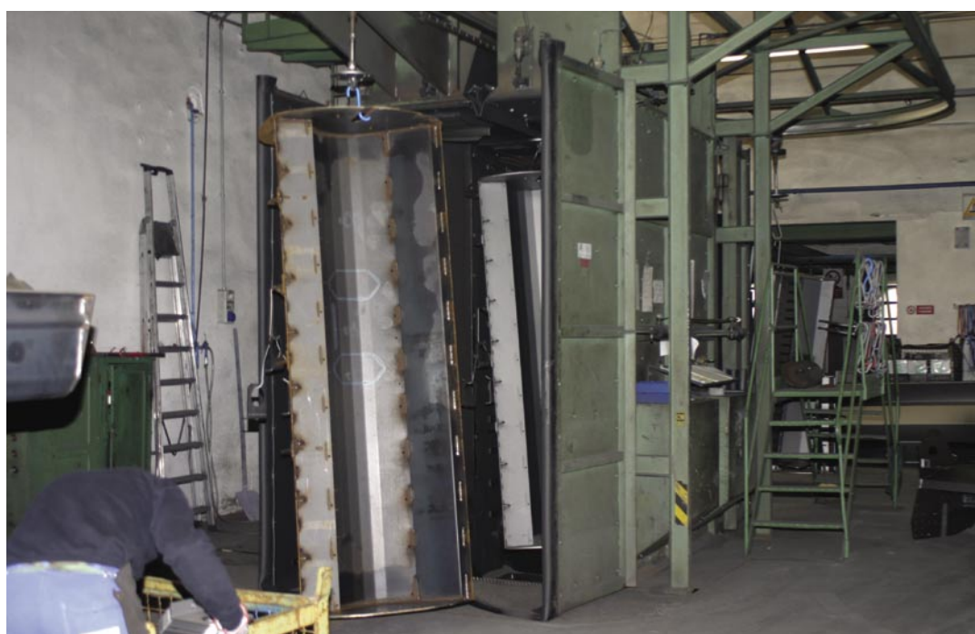
Fig. 9 - La granigliatrice automatica a grappolo con il telaio grezzo in ingresso.
