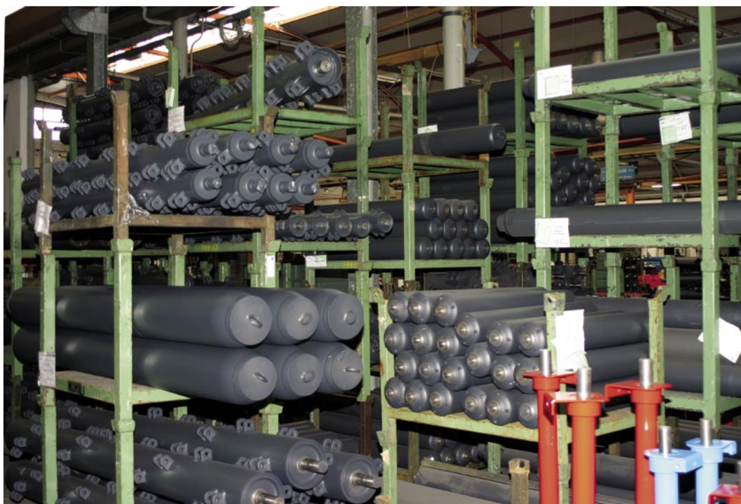
Fig. 12 - L'area di stoccaggio dei rotori e dei rulli verniciati con un fondo antiruggine nero.
