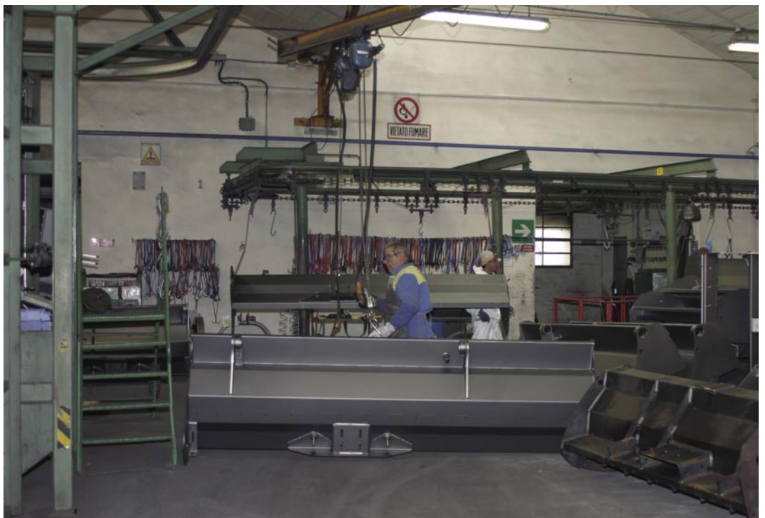
Fig. 5 - La prima zona dello stabilimento produttivo: i pezzi in ingresso, dopo la granigliatura automatica, vengono appesi alla catena di verniciatura.
